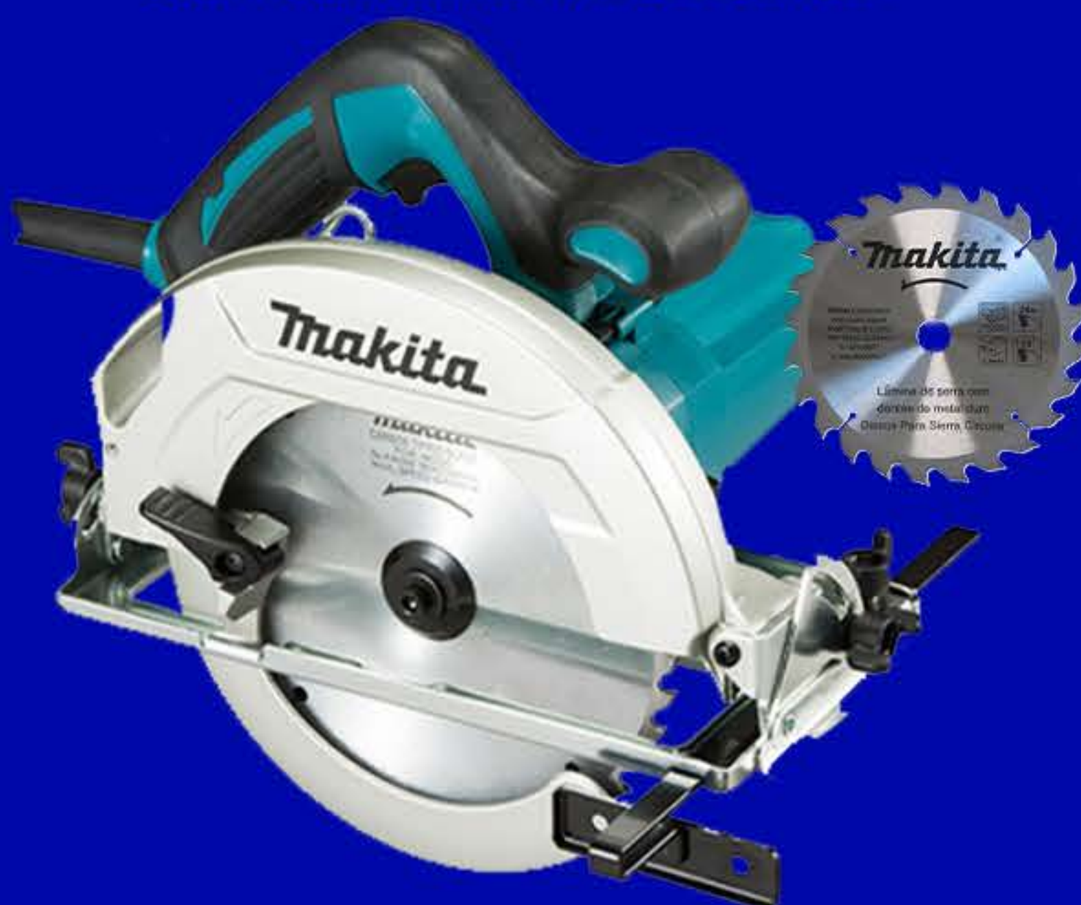
SERRA CIRCULAR 7.1/4 HS7010 110V - 1600W - 5500RPM - MAKITA ACOMPANHA LÂMINA 7.1/4" X 24 DENTES
